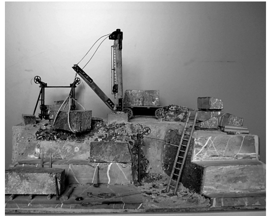
Villmar/Lahn, Abbau von Lahnmarmor mit Seilsäge und Derrickkran, Modell von A. Becker
