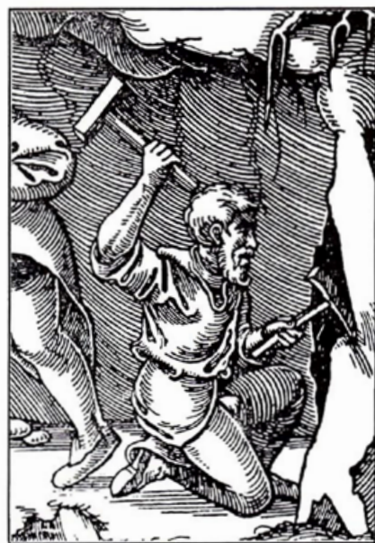
Im Spätmittelalter und der Frühen Neuzeit war die Arbeit mit Schlägel und Eisen typisch für den europäischen Bergbau. (G. Agricola, De Re Metallica Libri XII, Basel 1557)
