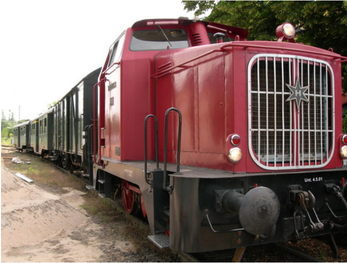
Museumseisenbahn im Hespertal, Diesellok V 9: HTB V 9 Henschel, Baujahr 1957, Fabrik-Nr. 29201, Bauart Bdh, Leistung 240 PS, Höchstgeschwindigkeit 60 km/h, vormals Eisenbahn & Häfen Duisburg, Zuglok für Museumszug (2006).
