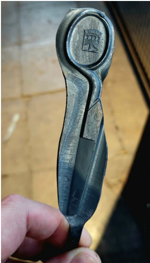
Ein Scherenrohling in der Gesenschmiede Hendrichs des LVR-Industriemuseums Solingen (2023). Fotograf/Urheber: Franz-Josef Knöchel
