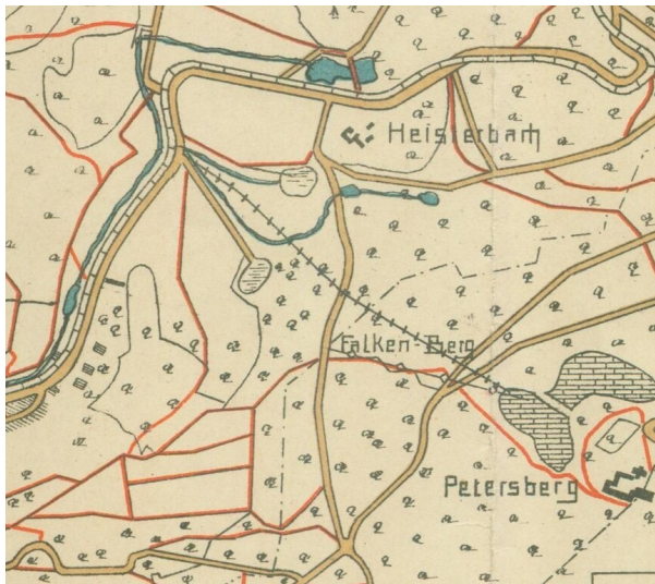
Steinbrüche am Peterberg Nord und Ost: Der Verlauf der Bremsbahn vom Petersberg Nordbruch bis in das Heisterbacher Tal ist in dieser Wanderkarte von 1906 als dünne Linie mit Querstrichen eingetragen. Fotograf/Urheber: unbekannt
