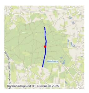
Mitten durch den Dämmerwald führt eine unterirdische Öl- und eine Gasfernleitung. Die Trasse verläuft von Süden nach Norden, teils entlang der Wege "Zum Brand" und "Zum Abendhorst". Zu erkennen ist dies u.a. an einem baumlosen Grünstreifen.
