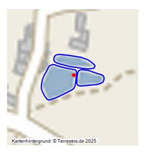
Die Wassermühle wurde mittels drei Teiche mit Wasser versorgt, die durch den Mühlengraben mit Wasser des Trierbaches gespeist werden. Vom Teich wird das Wasser zum unterschlächtigen Mühlrad geleitet und dann wieder in den Bach zurückgeleitet. Diese Teiche sind auf der Tranchotkarte von 1809 nicht dargestellt worden, aber waren dennoch aus dieser Zeit belegt. Sie sind heute funktionsfähig und werden für den Mühlenbetrieb für die Erzeugung von Elektrizitaät genutzt.
