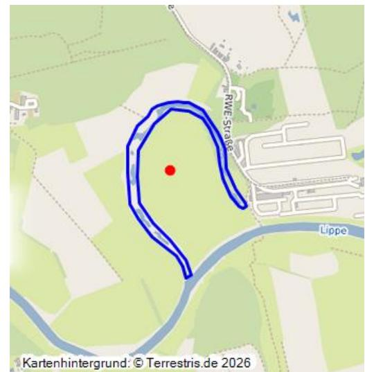
Der Altarm Obrighoven ist eine ehemalige Flussschleife der Lippe. Verbunden mit dem Bau eines Umspannungswerkes wurde die Lippeschlinge in den 1920er Jahren geschlossen. Die Begradigung sollte verhindern, dass sich die Lippe bei Hochwasser in der Flussschleife staut und durch Überschwemmung der ufernahen Bereiche die Anlage in Mitleidenschaft gezogen wird.
