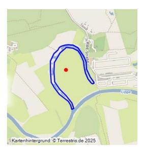
Der Altarm Obrighoven ist eine ehemalige Flussschleife der Lippe. Verbunden mit dem Bau eines Umspannungswerkes wurde die Lippeschlinge in den 1920er Jahren geschlossen. Die Begradigung sollte verhindern, dass sich die Lippe bei Hochwasser in der Flussschleife staut und durch Überschwemmung der ufernahen Bereiche die Anlage in Mitleidenschaft gezogen wird.
