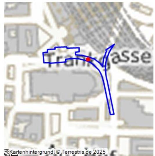
Schematischer Gleisplan der Haltestelle "Dom/Hauptbahnhof" der U-Bahn Köln, im südlichen Bereich der als Wendedreieck genutzte Ansatz für einen Rheintunnel (Zeichnung von 2009)
