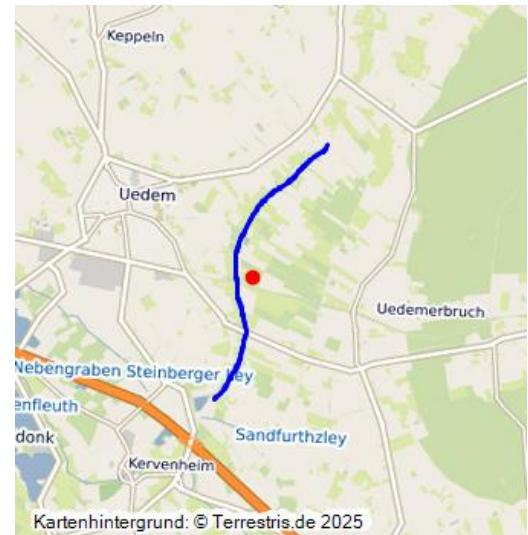
Dieser Haupt- bzw. Leitgraben ist im Register und Karte des Klevischen Katasters eingetragen (Nr. 11 Uedem von du Moulin und Enbers, 1734). Es handelt sich um den westlichen der drei nord-süd-orientierten Haupt- oder Leitgräben für die Entwässerung des Bruches, die im späten 13. Jahrhundert gegraben worden sind.
