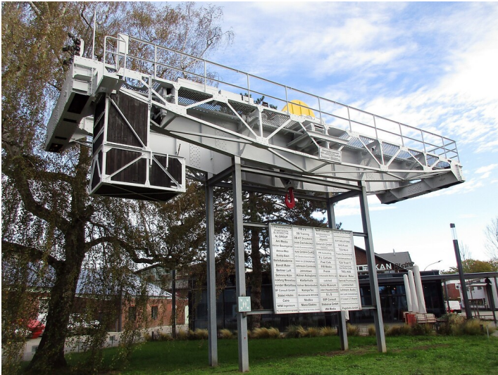
Ein Blickfang im Gewerbe- und Industriegebiet "Leskan Park" in Köln-Dellbrück ist der zentral aufgestellte Kran "No. 481" mit 30 Tonnen Tragkraft, im Jahr 1905 gebaut von der Benrather Maschinenfabrik AG (2022). Fotograf/Urheber: Franz-Josef Knöchel
