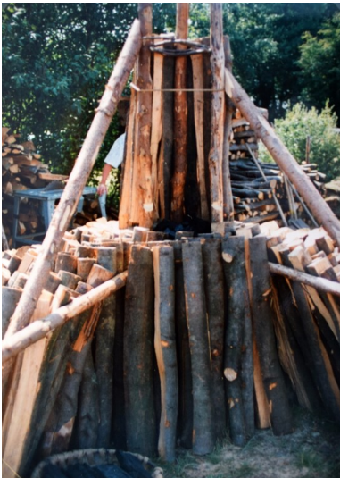
Quandelschacht eines Kohlemeilers (1998) Fotograf/Urheber: Digitales Fotoarchiv der Ortsgemeinde Welschneudorf
