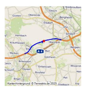
Infolge einer zwischen 2008 und 2014 erfolgten baulichen Umverlegung eines knapp 13 Kilometer langen Streckenabschnittes der Bundesautobahn A 4 aufgrund des Braunkohletagebaus Hambach, entstand zwischen der Anschlussstelle Düren und dem Kreuz Kerpen ein mehrere Kilometer langes Stück "Geisterautobahn".
