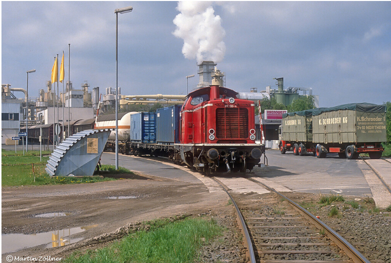
Ein Güterzug mit einer Diesellokomotive des Typs der DB-Baureihe V 100 / 211 bei der Ausfahrt aus der Spanplattenfabrik Rhenowest in Kaisersesch über das dortige Industriestammgleis (1990). Fotograf/Urheber: Martin Zöllner
