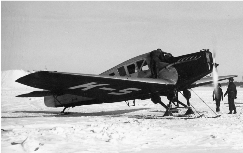
Verkehrs- und Frachtflugzeug des von 1919 bis 1932 produzierten Typs Junkers F 13 mit US-amerikanischer Kennung K-5 (1920er Jahre). Fotograf/Urheber: unbekannt
