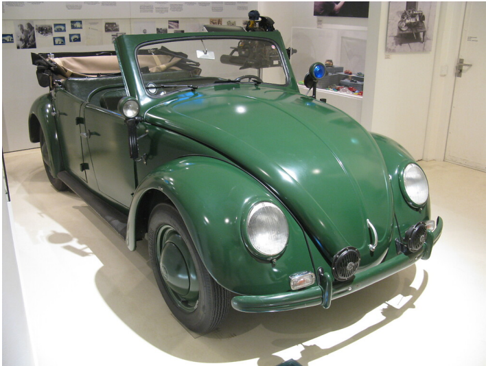
Vom Karosseriewerk Papler in Köln gefertigter Polizei-Streifenwagen auf Basis des VW Käfers (Volkswagen Typ 18A) aus dem Jahr 1951, ein offener Viertürer mit Stoffverdeck (2014).
