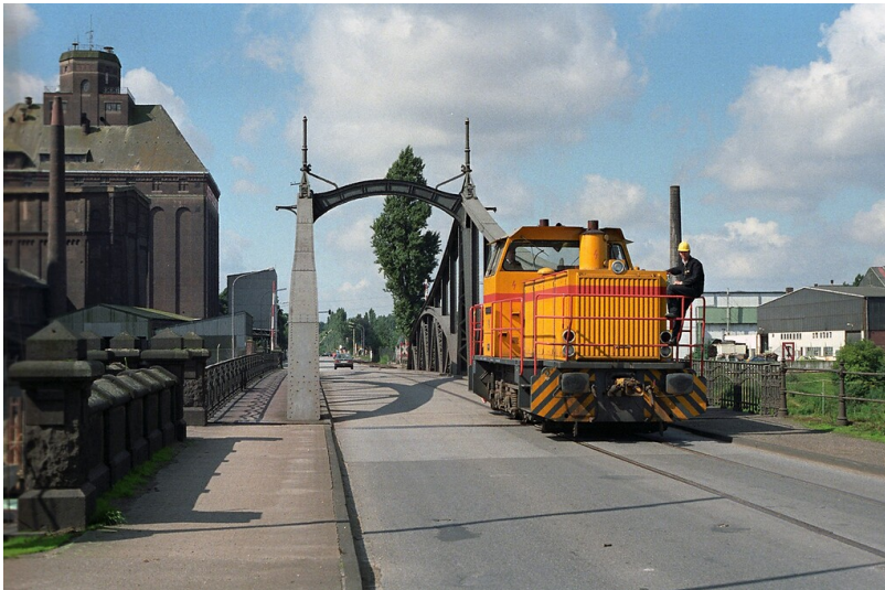
Die dieselhydraulische Güterlokomotive "Stadt Krefeld D II" des Typs Maschinenbau Kiel (MaK) G 763 C befährt die Jugendstil-Drehbrücke im Krefelder Rheinhafen über das zu diesem Zeitpunkt noch vorhandene Bahngleis (1988). Fotograf/Urheber: Hans Männel
