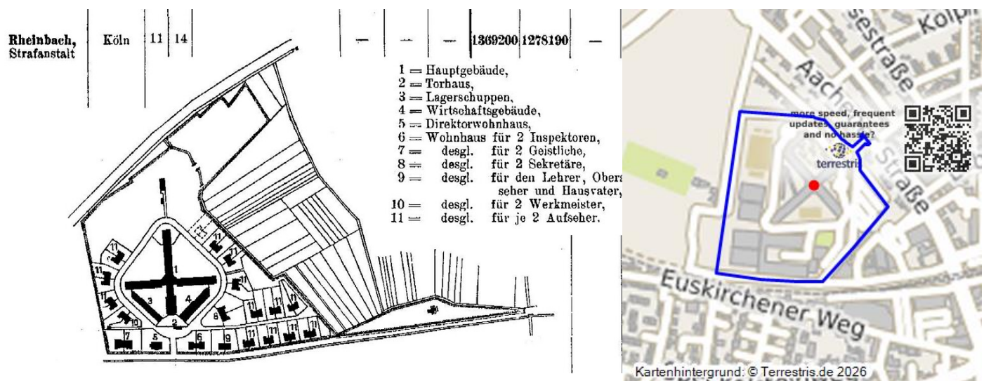
Grundrissplan der Strafanstalt Rheinbach im Regierungsbezirk Köln aus den "Statistischen Nachweisungen" (1917). Fotograf/Urheber: unbekannt
