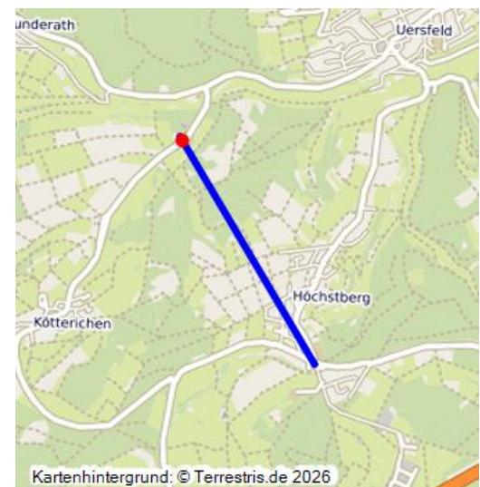
In der Gemarkung Uersfeld befand sich das **Schwerspat-Bergwerk Bergkrone**. Für den Abtransport des gewonnenen und gereinigten Schwerspats wurde 1902 eine Drahtseilbahn vom Bergwerk Bergkrone nach Höchstberg zum dortigen **Bahnhof** angelegt. Die Seilbahn hatte eine Länge von 1,8 Kilometer. In Höchstberg wurde eine Verladestation an der Eifelquerbahn (1878-1886) angelegt. Von dort wurde der Schwerspat nach Andernach und von dort mit dem Schiff zu den Verarbeitungswerken transportiert.
