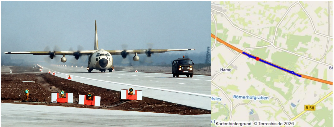
NATO-Übung "Highway 84" im März 1984: Ein militärisches Transportflugzeug Lockheed C-130 "Hercules" nach seiner Landung auf dem Notlandeplatz / Behelfsflugplatz auf der Bundesautobahn A 29 am Autobahndreieck Ahlhorner Heide bei Großenkneten (Niedersachsen). Fotograf/Urheber: SrA Glenda Pellum
