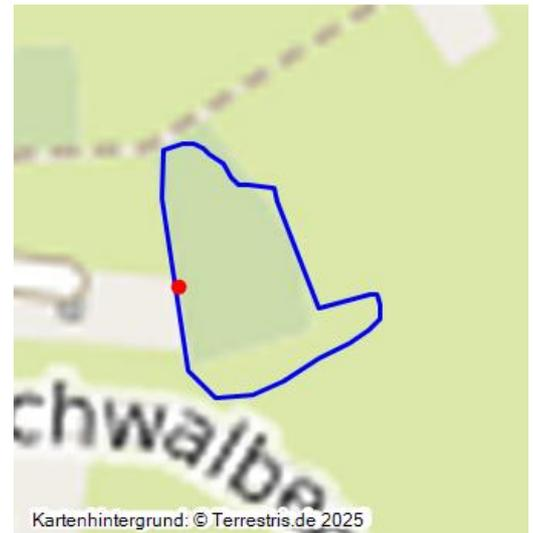
Kleiner Grauwackesteinbruch von 35 x 20 Metern Größe mit frontaler Halde. Er wurde im Halbkreis gegen den Hang angelegt, das Gelände zum Teil später angefüllt. Insgesamt nimmt das Areal eine Fläche von 160 x 60 Metern ein. Der Abtransport der Steine erfolgte per LKW nach Lindlar.
