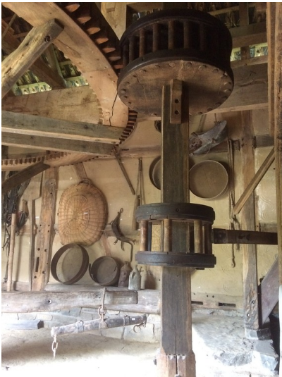
Antriebstechnik an der rekonstruierten Göpelmühle in einer Scheune am Heimatmuseum in Windeck-Dattenfeld (2017). Fotograf/Urheber: Pia Winter
