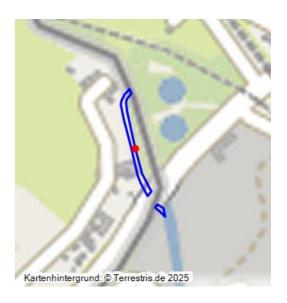
Der Mühlgraben der Baalsbrugger Mühle in Kerkrade wurde bei der Neuerrichtung der Baalsbruggermühle 1673 angelegt, wobei der Mühlengraben von der Wurm zur Mühle relativ kurz war. Der Graben ist relativ breit und geht unmittelbar östlich der heutigen Wurmbrücke von dem Wurm ab. Dadurch wurde das Wasser zum Mühlrad, das heute nicht mehr existiert, geleitet und dann über den weiteren Verlauf des Grabens wieder zurück in die Wurm eingeleitet. Ein Mühlenteich konnte nicht lokalisiert werden.
