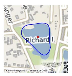
Wassergefülltes Restloch des Tagebaus Richard 45000217; nach 1922–dato; 2,7 ha groß, die Böschung wurde bei Einstellung des Tagebaubetriebes nur unzureichend gesichert, so kam es am 6. April 1993 am Pfingstanger zu einer Rutschung; nun stützt eine Vorschüttung aus Wasserbausteinen die Böschung; betrieben vom 1. Sandersdorfer Anglerverein 1930 e. V., sieben Fischarten (Aal, Barsch, Hecht, Karpfen, Rotauge, Rotfeder, Schleie).
