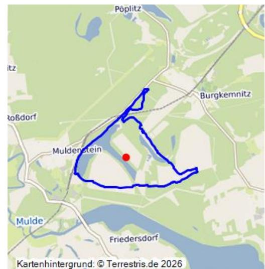
Erstes Abbaufeld des Tagebaus Muldenstein 45000135; 05.1953–08.60; 342,3 ha Fläche; 1951–1953 Entwässerung über Tagebau Luthers Linde 45000126, Aufschluss am 2. Mai 1953 mit Bagger ER 340-203, 1955 erster Kohlenzug zum Kraftwerk Zschorneowitz; zuvor Burgkemnitzer Forst, heute verfüllt, renaturiert, Felder, Restseen Grüner See 45000107, Blauer See 45000108.
