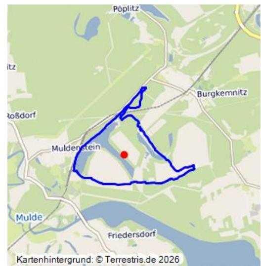
Erstes Abbaufeld des Tagebaus Muldenstein 45000135; 05.1953–08.60; 342,3 ha Fläche; 1951–1953 Entwässerung über Tagebau Luthers Linde 45000126, Aufschluss am 2. Mai 1953 mit Bagger ER 340-203, 1955 erster Kohlenzug zum Kraftwerk Zschornewitz; zuvor Burgkemnitzer Forst, heute verfüllt, renaturiert, Felder, Restseen Grüner See 45000107, Blauer See 45000108.
