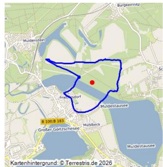
Abbaufeld des Tagebaus Muldenstein 45000135; 06.1959–12.1963; von Baufeld Ia 45000134 durch geologische Störung „Friedersdorfer Rinne“ abgetrennt, das Flöz ist hier aberodiert; Drehwinkel im Westen, Abbau von Nord nach Süd; Bagger 617 „Europabagger“ im Einsatz (größter Eimerkettenbagger Europas, 80 m breiter, 120 m langer, 40 m hoher Stahlkoloss, förderte stündlich 26.000 m<sup>3</sup>); zuvor Burgkemnitzer Forst, heute renaturiertes Landschaftsschutzgebiet „Tiefkippe Schlaitz“.
