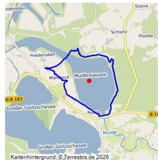
Abbaufeld des Tagebaus Muldenstein 45000135; 04.1963–04.1975; 690,6 ha Fläche, Erweiterung des Tagebaus nach Süden; durchzogen von geologischer Besonderheit „Bärenholzrücken“, einer Aufwölbung des Liegendquarzsandes und der Liegendkohle, die ein schwach ausgebildetes Flöz bedingt; zuvor Königlicher Forst Zöckeritz, heute mit Muldestausee geflutet.
