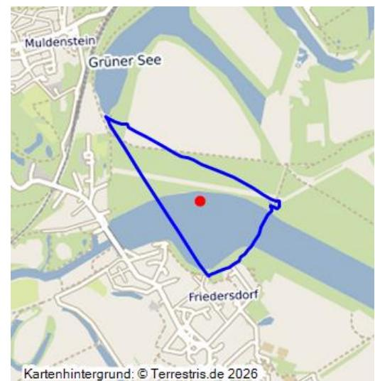
Abbaufeld des Tagebaus Muldenstein 45000135; 03.1961–12.1966; 87 ha Fläche, Drehwinkel im Westen, Abbau von Nord nach Süd, Schwierigkeiten durch Fundamente und Leitungen im Boden, Bagger 143 SRs 315, Bagger 518 E 800 (danach verschrottet); zuvor Tongrube und Burgkemnitzer Forst, heute verfüllt, renaturiert, Muldenstausee 45000143.
