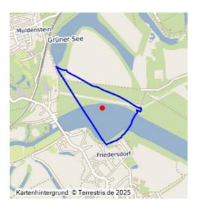
Abbaufeld des Tagebaus Muldenstein 45000135; 03.1961–12.1966; 87 ha Fläche, Drehwinkel im Westen, Abbau von Nord nach Süd, Schwierigkeiten durch Fundamente und Leitungen im Boden, Bagger 143 SRs 315, Bagger 518 E 800 (danach verschrottet); zuvor Tongrube und Burgkemnitzer Forst, heute verfüllt, renaturiert, Muldenstausee 45000143.
