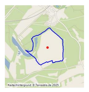
Abbaufeld des Tagebaus Muldenstein 45000135; 06.1959–12.1963; 123,2 ha Fläche, am nordöstlichen Rand des Tagebaus, Drehwinkel im Westen, Abbau von Süd nach Nord, Bagger 282 ERs 560, 197 ERs 500, 60 SRs 250, 291 ERs 400; erschwerter Abbau durch unregelmäßige Flözlagen und aufgewölbten Porphyrrücken; zuvor Burgkemnitzer Forst, heute verfüllt und landwirtschaftliche Fläche.
