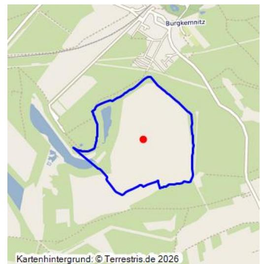
Abbaufeld des Tagebaus Muldenstein 45000135; 06.1959–12.1963; 123,2 ha Fläche, am nordöstlichen Rand des Tagebaus, Drehwinkel im Westen, Abbau von Süd nach Nord, Bagger 282 ERs 560, 197 ERs 500, 60 SRs 250, 291 ERs 400; erschwerter Abbau durch unregelmäßige Flözlagen und aufgewölbten Porphyrrücken; zuvor Burgkemnitzer Forst, heute verfüllt und landwirtschaftliche Fläche.
