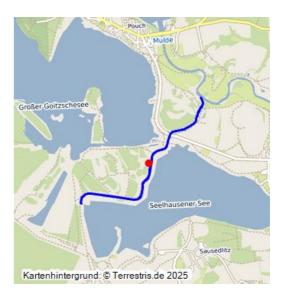
Künstlicher Abfluss der Flüsse Leine und Lober in dem Fluss Mulde; die natürlichen Flussläufe mussten dem Tagebau Goitsche weichen; die Baufeldfreimachung für den Tagebau Rösa erforderte 1982 eine erneute Umverlegung; Länge von 16,3 km; Zeitweise auch für die Flutung des Tagebaurestloches Seelhauser See genutzt; Quelle : Benndorf, Stadt Delitzsch; Mündung: Zwischen Pouch und Löbnitz.
