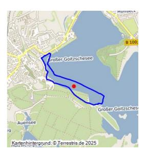
Abbaufeld Niemgk des Tagebaus Goitsche (45000043); 1978–1985; 104,7 ha Fläche; Devastierung des Ortes Niemegk nötig (45000102), Kohleflöz liegt in der Niemegker Senke 20 m tiefer, daher muss Grundwasser aufwendig bis auf Höhe des Meeresspiegels abgesenkt werden; heute südwestlicher Bereich des Großen Goitzschesees (45000033).
