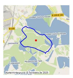
Erstes Abbaufeld des Tagebaus Goitsche (45000043); 1951–1960; 636,3 ha Fläche; eigentlich Aufschluss für 1940 geplant, verzögert wegen des Zweiten Weltkrieges; erster Aufschluss mit Menck-Löffelbagger; zuvor "Forst Zöckeritz" und ursprünglicher Verlauf des Leinegrabens, heute verfüllt, renaturiert und von Radwegnetz durchzogen.
