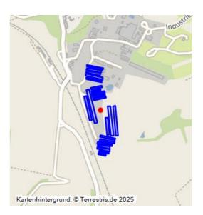
Komplex aus 25 Trockenschuppen der Grube Naumburg; 1872-1936; seit Gründung der Grube Naumburg wurden in 3 Nasspressen Torfziegel gepresst und in 25 langschmalen Trockenschuppen getrocknet; nach Eröffnung der Brikettfabrik I der Grube Naumburg 1899 wurden diese zunehmend überflüssig, sind aber auf den Messtischblättern bis 1937 eingezeichnet; ab 1936 abgerissen, wegen leichter Standbauweise spurenlos verschwunden, keine Geländemerkmale davon mehr erhalten.
