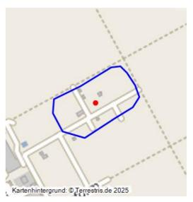
Bruchfeld der Grube Sophie; 1871–1882; Gelände mit heftigen Setzungen von bis zu 3,5 m Niveauunterschied; Schacht derzeit nicht lokalisiert; heute von Kleingartenanlage bebaut, darin eine sehr tiefe Senke.
