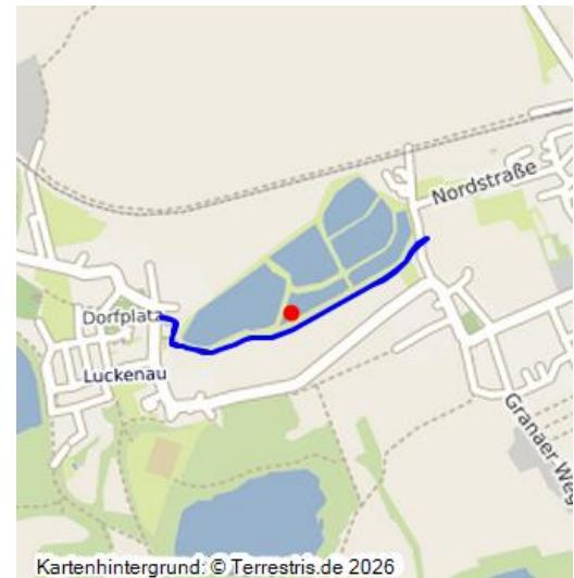
Verlegung des Maibaches für die Grube Virginia; 1895–1955; künstlicher Bachlauf in einem Graben; wasser technische Anlage in Vorbereitung des Tagebaus (44000693); in Nutzung.
