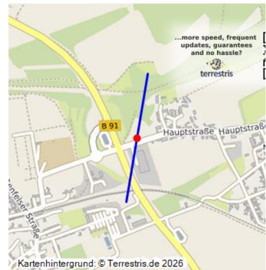
Seilbahn zwischen Grube Gottlob II und Briketfabrik Theißen; 1910–vor 1924; Trasse einer 700 m langen Seilbahn zur Belieferung der Briketfabrik; Masten abgebaut, Gelände überformt und durch andere Trassen zerschnitten.
