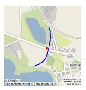
Damm eines Anschlussgleises zu den Fabriken Grube Emma und Grube Kurt; nach 1871–1950/60; Anschlussbahn Normalspur, erhöhter Bahndamm mit Brückenbauwerk; ab 1936 Streckenerweiterung bis Groitzschen (44000274), zuletzt Teilbetrieb zum Tagebau Streckau; Brücke abgebaut, Damm mit Stützmauer erhalten (44000629), bewaldet.
