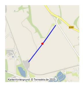
Seilbahn zwischen Grube Paul II und Paul I; 1903–1920; 1500 m Trassenlänge, später durch untertägige Kettenbahn ersetzt, die konkordant zu der Seilbahnstrecke verlief; Masten abgebaut, Feldweg oder Baum- und Strauchbewuchs, keine Spuren im Gelände sichtbar; in Fabriknähe ein Brückenpfeiler der Kettenbahnrampe erhalten.
