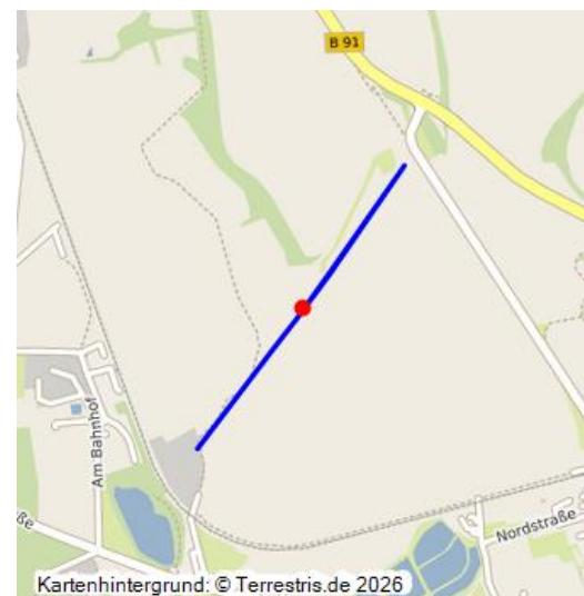
Seilbahn zwischen Grube Paul II und Paul I; 1903–1920; 1500 m Trassenlänge, später durch untertägige Kettenbahn ersetzt, die konkordant zu der Seilbahnstrecke verlief; Masten abgebaut, Feldweg oder Baum- und Strauchbewuchs, keine Spuren im Gelände sichtbar; in Fabriknähe ein Brückenpfeiler der Kettenbahnrampe erhalten.
