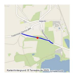
Rückverlegung des Maibachs; nach 1940; nach Verfüllung von Tagebaurestloch (44000640) und Rekultivierung wurde der Maibach rückverlegt; zuvor für Wasserhaltung der Tagebaue Hermann Schaede und Gaumnitz nach Norden verlegt; letzter künstlicher Verlauf in Nutzung.
