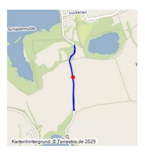
Trasse einer Kohlebahn vom Tagebau Streckau zur Fabrik Groitzschen; 1936–1960; Grubenbahn mit Großraumwagen, 900 mm Spurweite, für Trassierung sowohl Dämme als auch Geländeeinschnitte angelegt; Gleise entnommen, heute asphaltierter Weg als Teilstück des Recarbo Kohle-Rad- und Wanderwegs.
