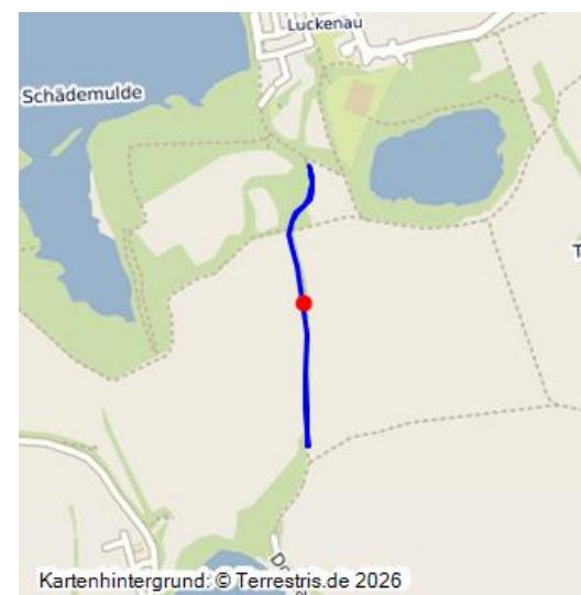
Trasse einer Kohlebahn vom Tagebau Streckau zur Fabrik Groitzschen; 1936–1960; Grubenbahn mit Großraumwagen, 900 mm Spurweite, für Trassierung sowohl Dämme als auch Geländeeinschnitte angelegt; Gleise entnommen, heute asphaltierter Weg als Teilstück des Recarbo Kohle-Rad- und Wanderwegs.
