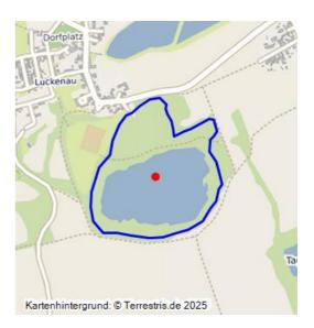
Tagebau der Grube Neue Sorge III; 1912/17–1932; Tagebau überbaggert Schacht und Tagesanlagen der Grube Neue Sorge II; Tagebau mit Innenkippe verfüllt, renaturiert und aufgeforstet, Tagebaurestloch als See (zeitweise Badegewässer) genutzt, nach Böschungsrutschung in den 1980er-Jahren aufgehoben.
