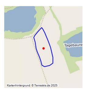
Bruchfeld der Grube Neue Sorge II; 1880–ca. 1920; Abbaufeld Tiefbau; Gelände mit Setzungserscheinungen; deutlicher Niveauunterschied östlich vom Weg Weidau–Granau, mit steil abfallender Böschung; Ackerland.
