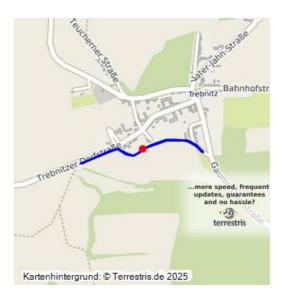
Verlegung des Maibaches bei Trebnitz; 1935–1940; für Betrieb des Tagebaus Gaumnitz (44000641) Verlegung des Baches nach Norden, entlang des Ortsrandes und parallel nördlich zur Bahnhofstraße; der Maibach wurde insgesamt fünfmal verlegt; das westliche Teilstück als Graben in Nutzung.
