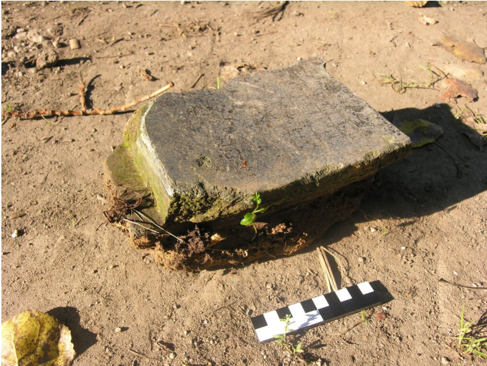
Aschehalde der Schwelerei Grube Neu-Gröben - Schamottestein, Segment eines Schwelzylinders, glasiert; Maßstab dl-by-de/2.0 cm Fotograf/Urheber: NAME FEHLT
