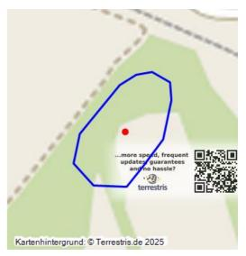
Aschehalde der Schwelerei Grube Neu-Gröben; 1891–1918; Abfallhalde nordöstlich der Fabrik; 1912 kartiert; später von Abraum der Grube Vollert überdeckt (44000480); am Fuße der Halde noch originäre Reste, mit Schamottesteinen.
