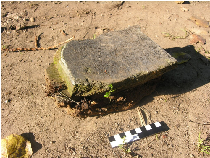
Aschehalde der Schwelerei Grube Neu-Gröben - Schamottestein, Segment eines Schmelzylinders, glasiert; Maßstab dl-by-de/2.0 cm Fotograf/Urheber: NAME FEHLT
