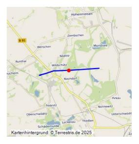
Seilbahn von Grube Margarethe zur Brikettfabrik von Voß; 1907–1932; 4750 m Trassenlänge, zwischen Grube Margarethe bei Mutschau und der Grube von Voß; führte zeitweise über bestehendes Tagebaufeld der Grube Kamerad/Deuben; Belieferung der Brikettfabrik von Voß; Masten abgebaut, Gelände zumeist überbaggert und überschüttet, auf verbliebenem Acker- und Brachland keine ersichtlichen Spuren.
