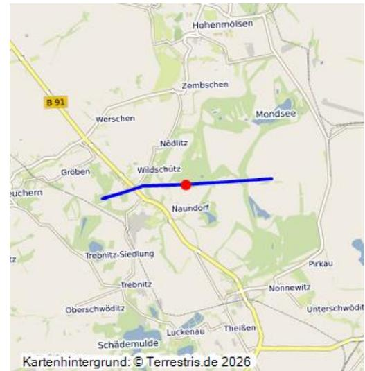
Seilbahn von Grube Margarethe zur Brikettfabrik von Voß; 1907–1932; 4750 m Trassenlänge, zwischen Grube Margarethe bei Mutschau und der Grube von Voß; führte zeitweise über bestehendes Tagebaufeld der Grube Kamerad/Deuben; Belieferung der Brikettfabrik von Voß; Masten abgebaut, Gelände zumeist überbaggert und überschüttet, auf verbliebenem Acker- und Brachland keine ersichtlichen Spuren.
