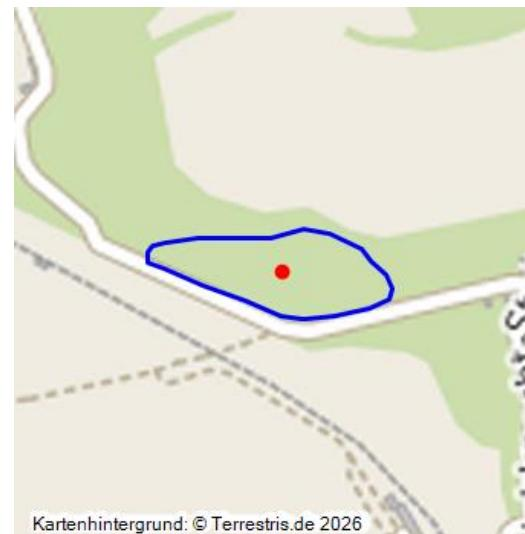
Aschehalde der Fabrik Grube von Voß; nach ca. 1920; Aschedeponie mit Fabrikabfällen, im extensiv genutzten Werksgelände zu beiden Seiten des erhöhten Damms eines Rangiergleises; mit Bäumen und Sträuchern bewachsen.
