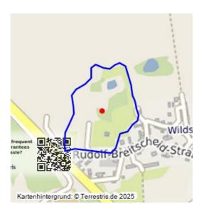
Tagebau der Grube Hedwig; 1887–1910; Tagebau mit Schachtförderung; Grube von ca. 350 x 300 m Ausdehnung, z.T. über vorherigem Tiefbaufeld (44000433); dabei 1906 Werksgelände mit Schwelerei überbaggert (44000183); mit Abraummaterial verfüllt; rekultiviert als Forst, Weideland und Gärten, im östlichen Grubenbereich temporäre Feuchtgebiete, gegenüber Ortslage Wildschütz eine ausgeprägte Böschung.
