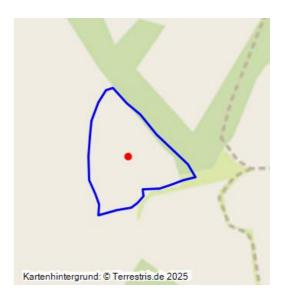
Bruchfeld der Grube Emilie; 1880–1919; wellige Geländeoberfläche mit Setzungserscheinungen; nicht überbaggerter bzw. überkippter Bereich des Tiefbaufeldes der Grube Emilie; Ackerland mit einzelnen Tagesbrüchen.
