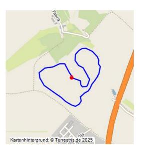
Bruchfeld der Grube von E. Koch; nach 1871–um 1910; vermutliches Abbaufeld einer bisher unbekannten Grube, Förderung für die Fabrik des E. Koch (44000757); eventuell zum Teil Abbaufeld der Grube Bruno/Waldau; Gelände mit starken Setzungserscheinungen von bis zu 10 m Höhendifferenz; Ackerland, im Luftbild partiell dichte Streuung rundlicher Flecken als Indiz ehemaliger Tagesbrüche erkennbar.
