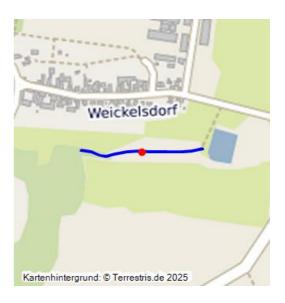
Schachthalden eines Entwässerungsstollens; vor 1850; vermutliche Lichtlöcher eines Stollens zur Wasserhaltung, Rösche (Wasserstollen) für das benachbarte Grubenfeld (44000404); wasserabführender Graben umgeht eine Senke mit Teich, Hinweis auf Tagebauversuch; heute Weideland mit Baumgruppen.
